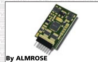
By ALMROSE 6087 Decoder funzioni per pilota Vivalto: gestione luci di marcia, terzo faro (digitale) autonomo, luce interna On/Off, regolazione luminosità luci interne e luci di marcia. Lighting decoder for Vivalto driving coach.
