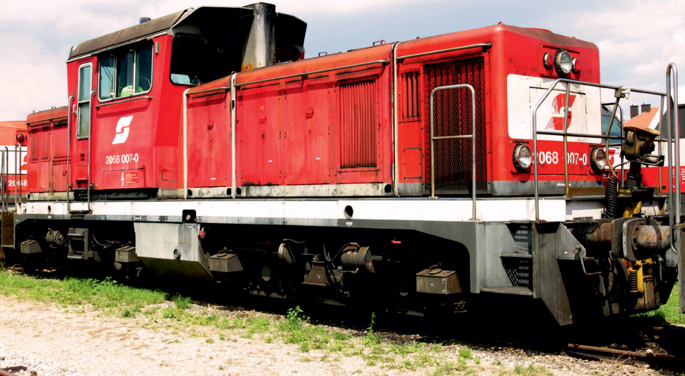
Mitte der 1980er-Jahre stellten die ÖBB erste Überlegungen zur Konzipierung neuer Dieselloks für den Verschubdienst an. Eine dreiachsige Lok schied wegen der unruhigen Laufeigenschaften im Geschwindigkeitsbereich um 100 km/h sofort aus. Die Lösung sah man in einer vierachsigen Drehgestelllok. Die Jenbacher Werke erhielten 1989/90 den Auftrag fünf solcher Loks an die ÖBB zu liefern, die als 2068.001 bis 005 eingereiht wurden. In den Jahren 1992 bis 1994 folgten noch 55 weitere Exemplare.
